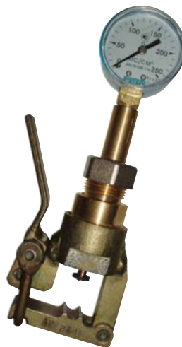
КГ 7638М1.000-02 с манометром для измерения давления в баллонах
