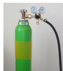
Рис. 3. Редуктор, с присоединенным рукавом установленный на баллон с элегазом
